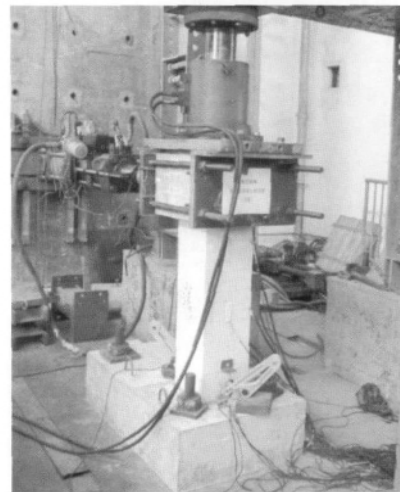
图 5 实验加载装置图 Fig. 5 Diagram of loading apparatus
